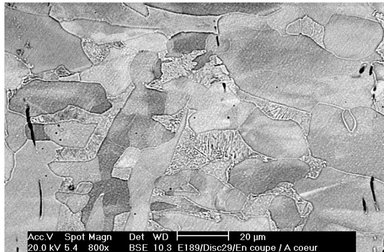
Figure B-3 : Microstructure ferritoperlitique du XC18.
