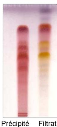
**Figure III 27. CCM des deux fractions obtenues après la précipitation des tanins sur APY F<sub>1</sub> (élution : AcOEt / MeOH / H<sub>2</sub>O (100 : 13.5 : 10) ; révélation : réactif à la vanilline sulfurique).**
