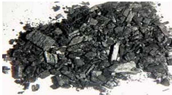
**Fig. 4.6:** *Photographie du bois imprégné après pyrolyse*
