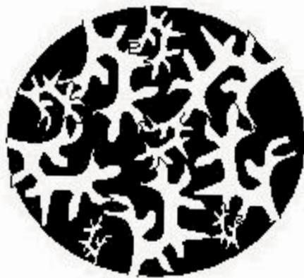
**Fig. 2.14:** *Reseau poreux d'un grain de charbon actif*
