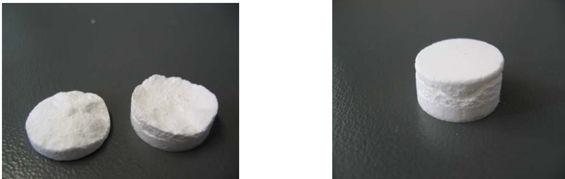
Figure II.11. Clivage d'un compact du lactose après éjection.
