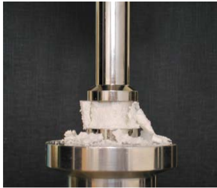
Figure III.13. Compact de Vivapur 102 au cours d'une compression simple.
