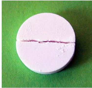
Figure III.1. Rupture diamétrale d'un compact plat de cellulose microcristalline Vivapur 102.
