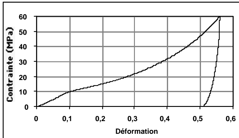
Figure III.26. Courbe de compression des cinq tranches à 60 MPa.
