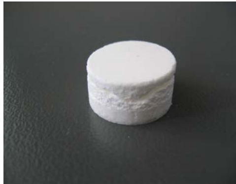
Figure I.3. Clivage d'un compact de lactose après éjection.
