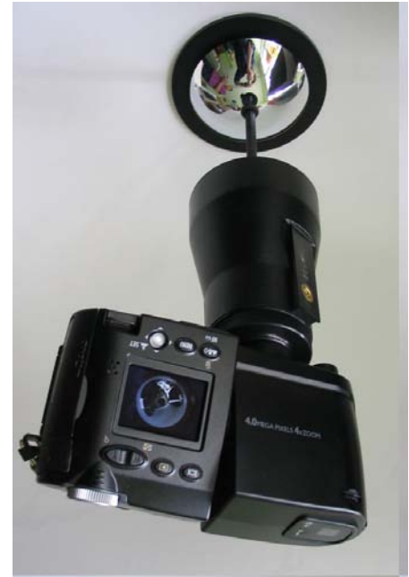
FIG. 3.2: La géométrie d'une caméra catadioptrique et le modèle que nous utilisons (One-Shot360 de Panosmart).
