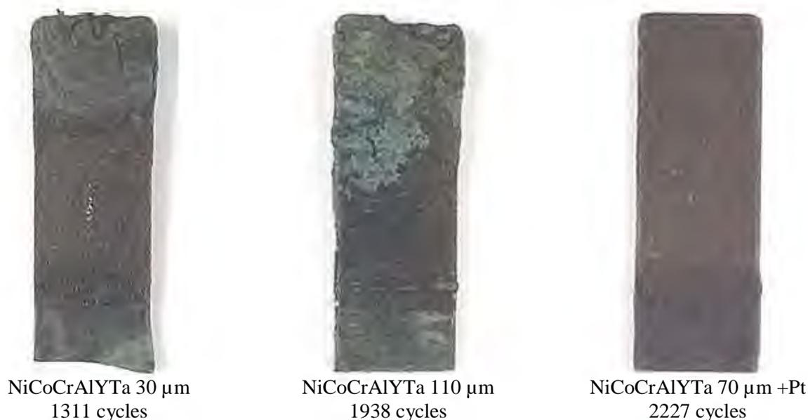
**Figure III-37. : Dégradation des éprouvettes corrodées à 900°C en banc brûleur**
