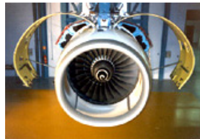
figure I.11 : ouverture des capots nacelle (©Aircelle)
