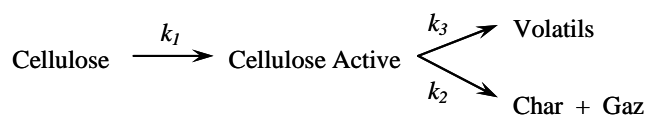
Figure I.III.10 : Schéma réactionnel modifié de la dégradation thermique de la cellulose d'après Bradbury et al. [1979].
