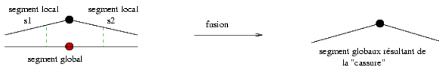
FIG. 6.1: Observation d'une cassure dans le segment global, résultant de l'appariement (en pointillés verts) du segment global avec deux segments locaux adjacents.
