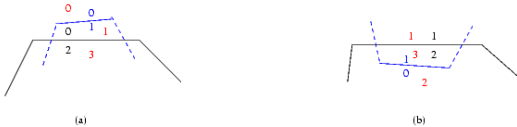
FIG. 7.49: Détection de petites zones incohérentes dans la carte. Dans ces exemples, les arêtes en bleu (avec des degrés d'occupation noirs indiqués en bleu) correspondent à celles du dernier polygone local inséré dans la carte. Les degrés d'occupation noirs des autres arêtes sont indiqués en noir et les degrés d'occupation rouge modifiés suite à l'insertion de ce dernier polygone sont indiqués en rouge. (a) Les degrés d'occupation noirs des lignes polygonales proches sont orientés dans le même sens : il s'agit sans doute d'un appariement manqué. (b) Les degrés d'occupation de ces lignes polygonales sont orientés dans des sens opposés : il s'agit plutôt d'un dépassement.
