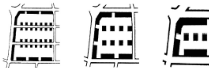
FIG. 2.2 – Effet de généralisation dû à l'échelle. La même scène est représentée à différentes échelles : 1 :25,000 / 1 :50,000 / 1 :100,000 (de gauche à droite). Le schéma est extrait de [80].
