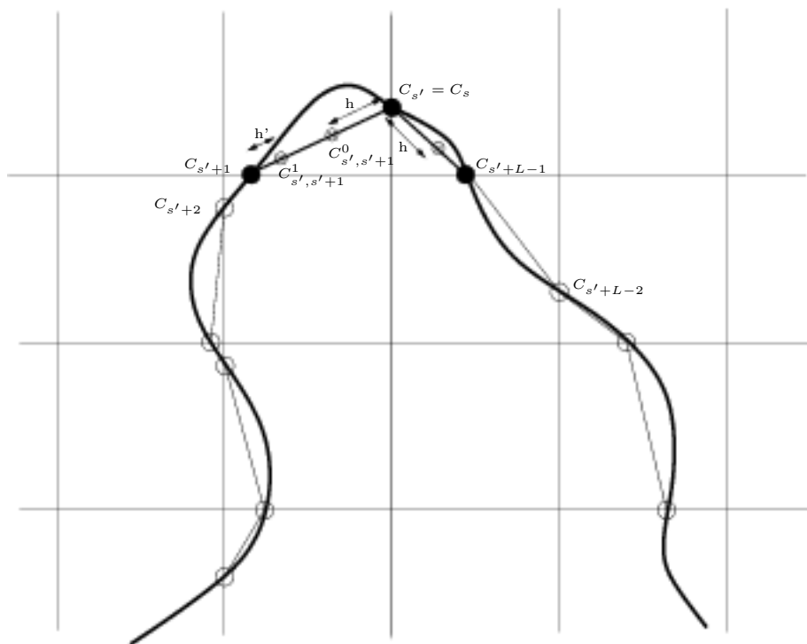
FIG. 6.4 – Schéma décrivant le mode d'échantillonnage avec une fonction de Bessel pour profil \Psi
