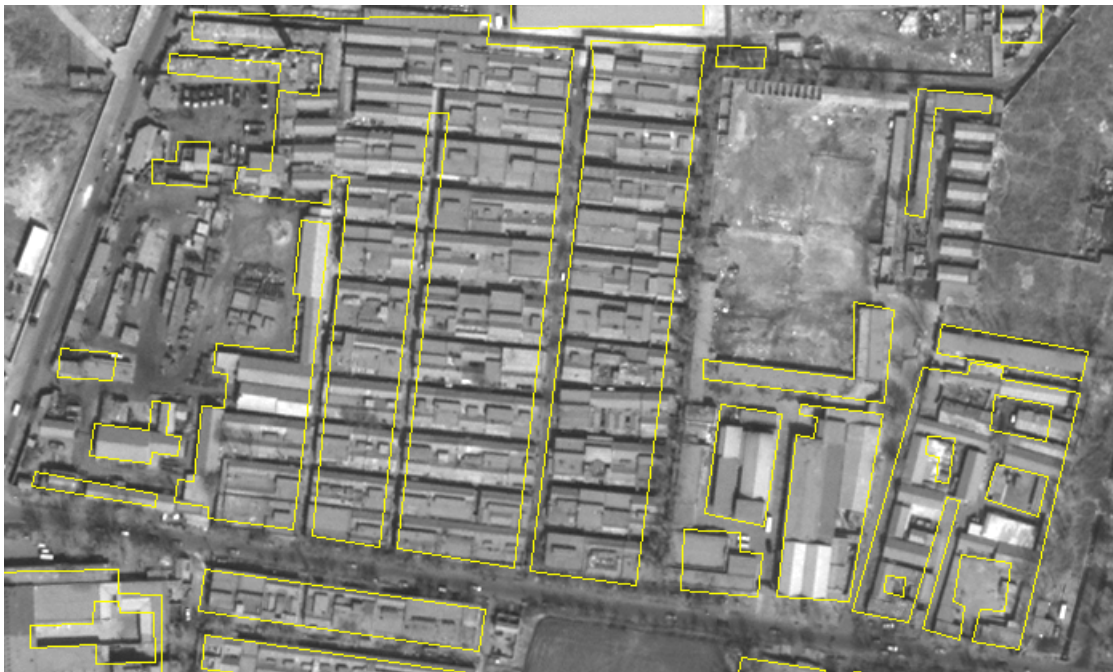
FIG. 2.4 – Superposition d'une carte du bâti (polygones jaunes) avec une image satellitaire illustrant l'effet de généralisation : un seul polygone cartographique englobe de nombreux bâtiments contigus.
