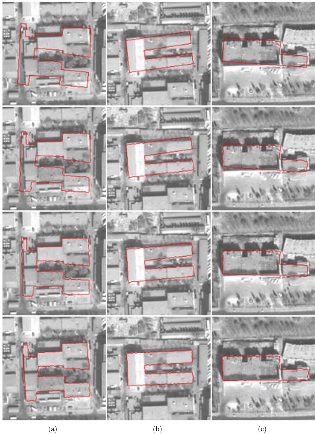
FIG. 5.13 – Sensibilité à l’initialisation : segmentation avec un contour actif basé sur l’information de contour (GVF) et avec contrainte de forme.
