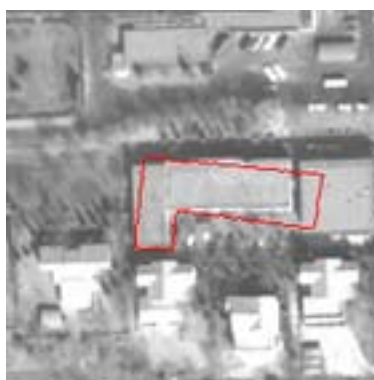
FIG. 5.23 – Segmentation avec un poids constant de contrainte de forme et le modèle Bayésien ( \lambda = 50 ).
