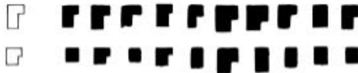
FIG. 2.1 – Erreurs de délinéation des contours : différentes segmentations (en noir) du même objet (vérité terrain en blanc) par plusieurs photo-interpréteurs. Le schéma est extrait de [80].
