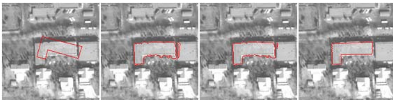
FIG. 5.22 – Segmentation avec une variation spatio-temporelle de la contrainte de forme et le modèle Bayésien ( \lambda_{min} = 27 , \lambda_{max} = 70 , d_0 = 7 ).
