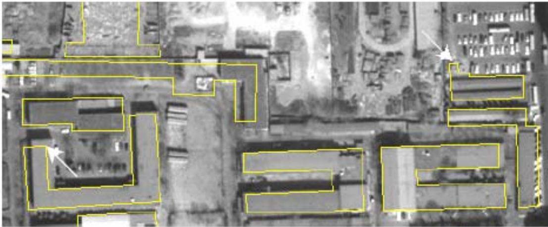
FIG. 2.3 – Superposition d'une carte du bâti (polygones jaunes) avec une image satellitaire. Les flèches blanches pointent des inexactitudes locales de forme de la carte.
