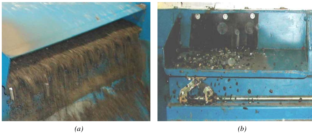
Figure 22 : Table densimétrique. (a) : sortie du compost par le bas ; (b) : sortie des refus lourds par le haut.
