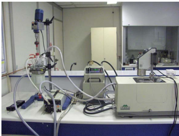
Figure 4-2 : Photographie du dispositif expérimental d'agrégation de la silice en cuve agitée avec circulation du milieu vers la cuve en ligne de l'Ultrasoner.
