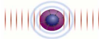
Figure 2-6 : Mécanisme de dissipation thermique de l'onde acoustique autour d'une particule en suspension dans un fluide.
