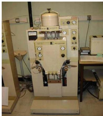
**Figure 2.10.** Thermobalance SETARAM (photo par Mathieu Delmas, reproduite avec sa permission)
