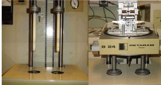
**Figure 2.11.** a) cannes d'alumine ; b) balance magnétique (photos par Mathieu Delmas, reproduites avec sa permission)
