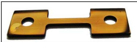
Figure B 1. L'aspect d'une éprouvette de traction
