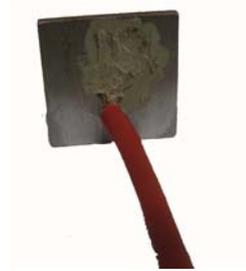
L'électrode de travail est immergée pendant une heure dans la solution électrolytique afin d'atteindre un état quasi stationnaire. Il s'agit d'une solution de chlorure de sodium à 0,1 M. La masse nécessaire pour chaque préparation a été calculé de la façon suivante :
