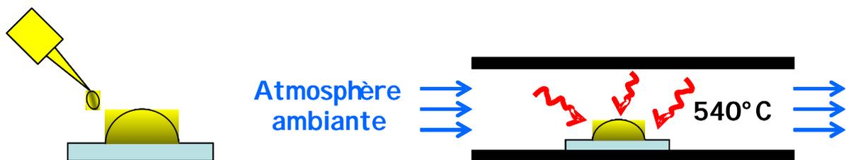
**Figure 4.23.** Présentation schématique du substrat avec la goutte d'eau salée (à gauche) et de la configuration de l'essai sans chargement mécanique (à droite).
