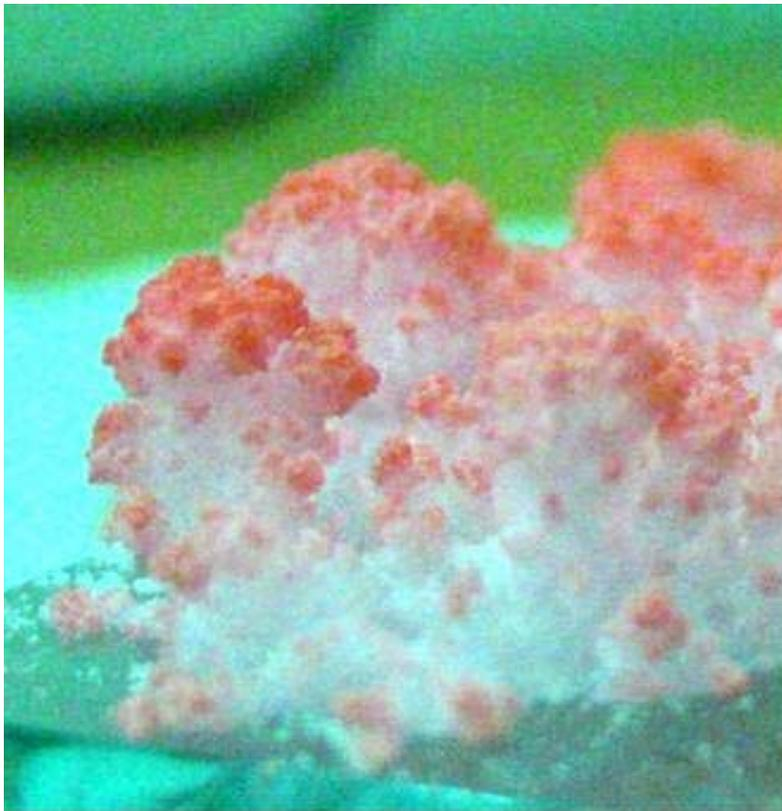
*Figure IV.2. Structure 'Chou fleur' de la halite. L'épaisseur de la couche de sel est de quelques millimètres.*
