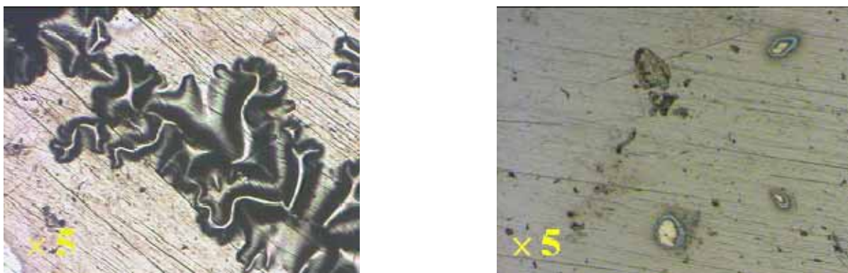
Figure VI.27 : Clichés optiques des échantillons d'acier SS304L revêtus de Cr(C) (gauche : e=0,5 \mu\text{m} , droite : e=0,2 \mu\text{m} )
