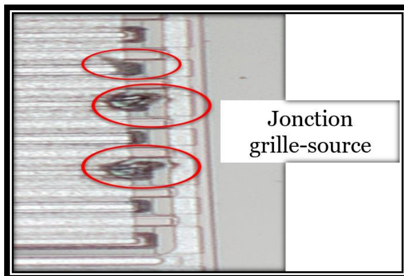
Figure 113: Défaillance observée après stress TLP sur totems pole en SiC.
