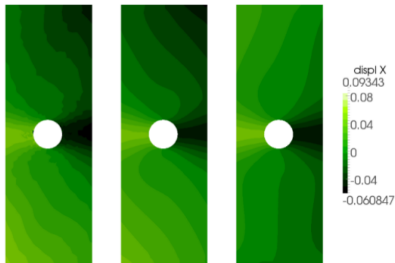
FIGURE 4.4 – Composante horizontale du champ de déplacement : mesure CIN (à gauche), simulation avec conditions aux limites expérimentales (au centre) et simulation avec conditions aux limites homogènes idéalisées (à droite)
