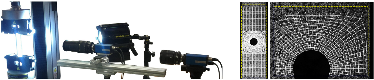
FIGURE 4.5 – Dispositif expérimental : les deux caméras font face à l'éprouvette, leur axe optique étant, autant que possible, perpendiculaire au plan de stratification. Ici, une platine est utilisée pour déplacer la caméra en champ proche afin de pouvoir prendre l'image en champ lointain. (à droite) la partie utile de l'image en champ lointain ainsi que l'image en champ proche.
