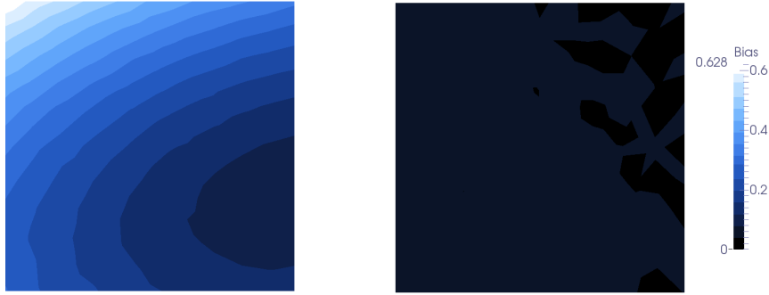
FIGURE 4.16 – Erreur sur le champ de déplacement mesuré à partir d’image synthétiques représentant une translation pure avec distorsions. À gauche, l’intégration pixel et à droite, l’intégration dans le repère monde.
