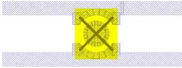
Figure IV.3 : Vue schématique des trois zones de dopage : la croix représente la zone d'implantation localisée, le rectangle du milieu représente le masque d'activation diffusion et les bras de part et d'autre sont les zones diffusées N++
