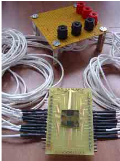
Figure IV.49 : Dispositif de test pour valider le rôle des diodes au niveau de l'adressage matriciel.
