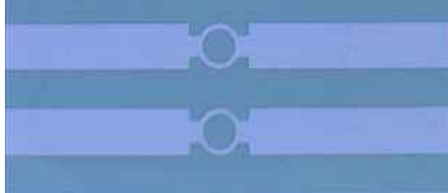
Figure III.13 : Vue au microscope optique du résultat de la gravure du poly silicium.
