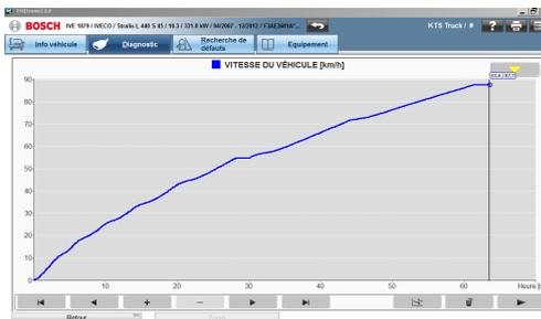
FIGURE 3 – Profil d'accélération d'un véhicule composé d'un semi-remorque / tracteur.
