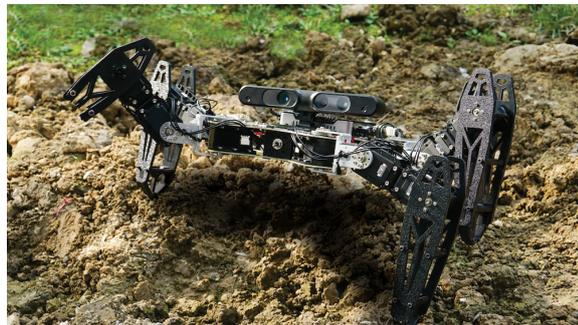
Figure 1 : Robot hexapode avec une patte brisée.
