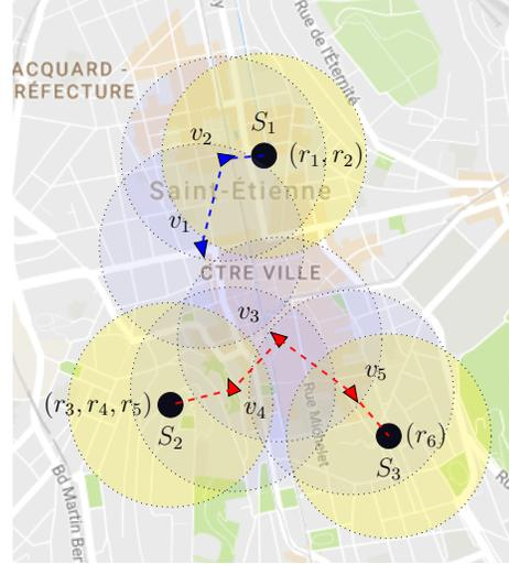
FIGURE 1 – Exemple d'une instance du problème d'allocation de taxi (TSAP) au temps  $t$ , où deux taxis ( $v_i$ ) peuvent uniquement interagir (lignes en pointillés) lorsqu'ils sont dans la même sphère de communication (cercles en pointillés). Les demandes ( $r_j$ ) sont émises aux sources ( $S_k$ ).
