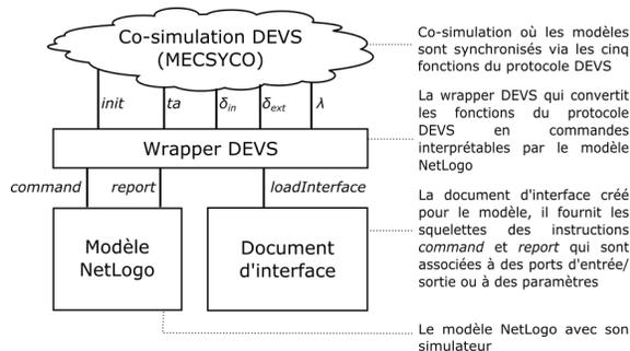
FIGURE 1 – Principe du wrapper NetLogo.
