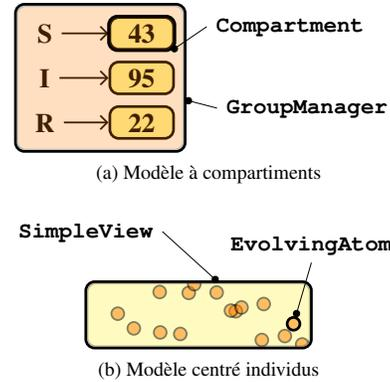
FIGURE 4 – (a) Structure d'un modèle à compartiments. Le `GroupManager` utilise une machine à états pour déterminer les flux entre compartiments. (b) Structure d'une simulation IBM. Les `EvolvingAtoms` possèdent leur propre machine à états et sont hébergés par un agent `SimpleView`.
