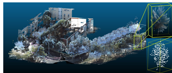
Figure 2.5 – Vue globale de notre acquisition LiDAR terrestre. On peut y distinguer des arbres, un arrêt de tramway ainsi qu'une petite résidence. A droite, un arbre est isolé puis sous échantillonné en un nuage de 512 points
