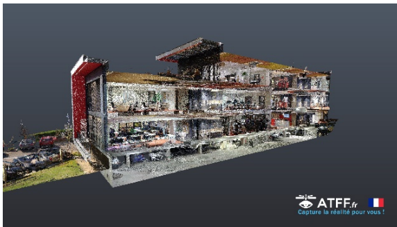
Figure 2.6 – Vue en coupe bâtiment CARL Software (société du groupe Berger-Levrault) en nuage de points, relevé LiDAR
