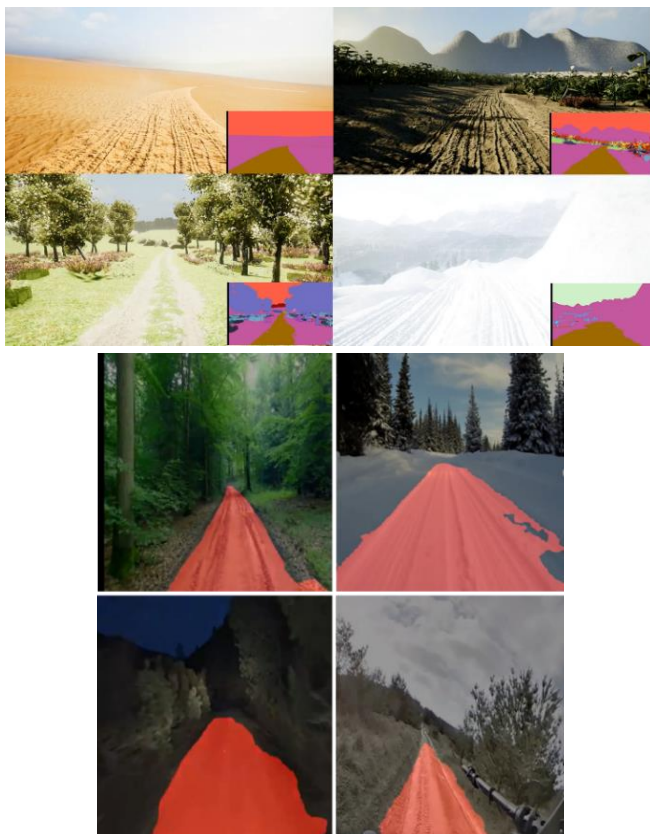
Figure 5 : En haut, des environnements générés avec AirSim et les labels de segmentation sémantique natifs. En bas, les résultats du module de détection de chemin intégrant ces données à l'apprentissage.
