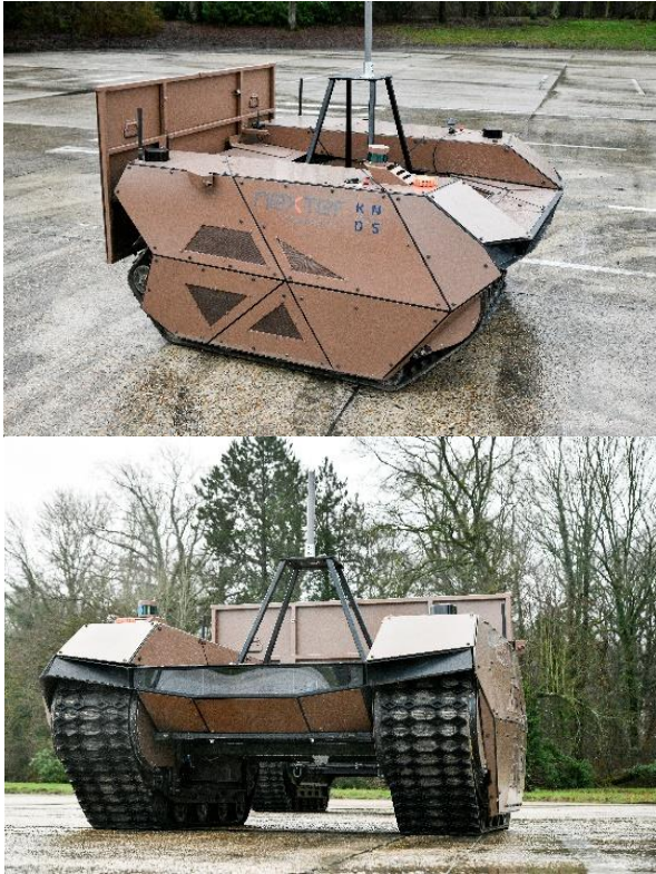
Figure 1 : Vues de l'Optio, sur base de plateforme chenillée Milrem et robotisée par Nexter. On peut distinguer ici les LIDAR 2D et 3D, ainsi que certaines caméras derrière la vitre centrale et sur les côtés.
