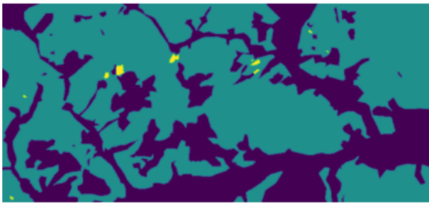
FIGURE 8 – Répartition des clusters labellisés sur la série d’images satellite du jeu de données Coupes de bois . La forêt est représentée en vert (156684 pixels), les zones d’activité humaine en bleu (86665 pixels) et les zones de coupes claires en jaune (639 pixels).
